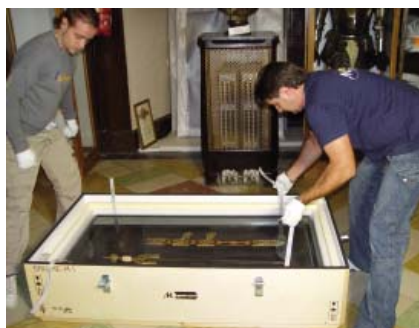
Disposició de la vitrina amb control climàtic passiu dins de la seva caixa de transport. Fotografia: cortesia d'Ignasi Millet.
