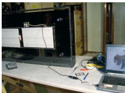
Programació del data logger per mesurar els nivells d'humitat relativa durant tot el procés de transport i d'exhibició de la peça. Fotografia: cortesia d'Ignasi Millet.
